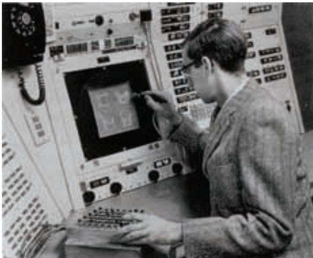
**Слева:** Прототип проекционного инструмента дизайнера и архитектора был создан фактически на базе осциллографа. Пользоваться им на практике было невозможно, но старт был дан.
